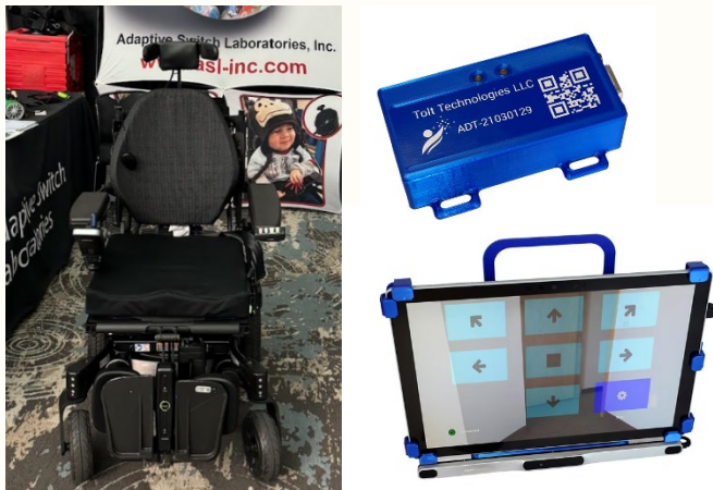
図5 視線入力による電動車椅子の操作 (Ability Drive: Tolt Technologies 社)
