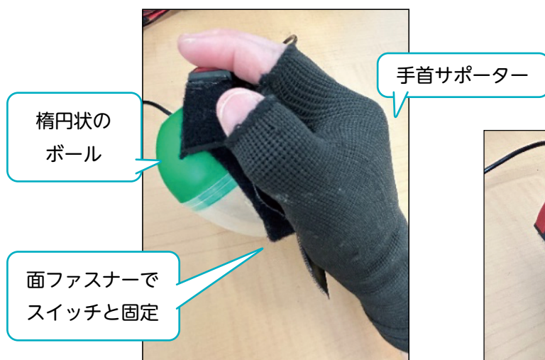
図 11 - 5 ボタンスイッチ改造後 1
